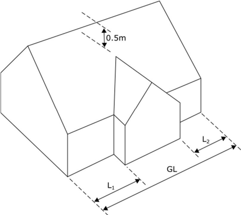
$L_1 + L_2$  (Trauflänge des Hauptdachs) = min. 50 % der Gebäudelänge GL
