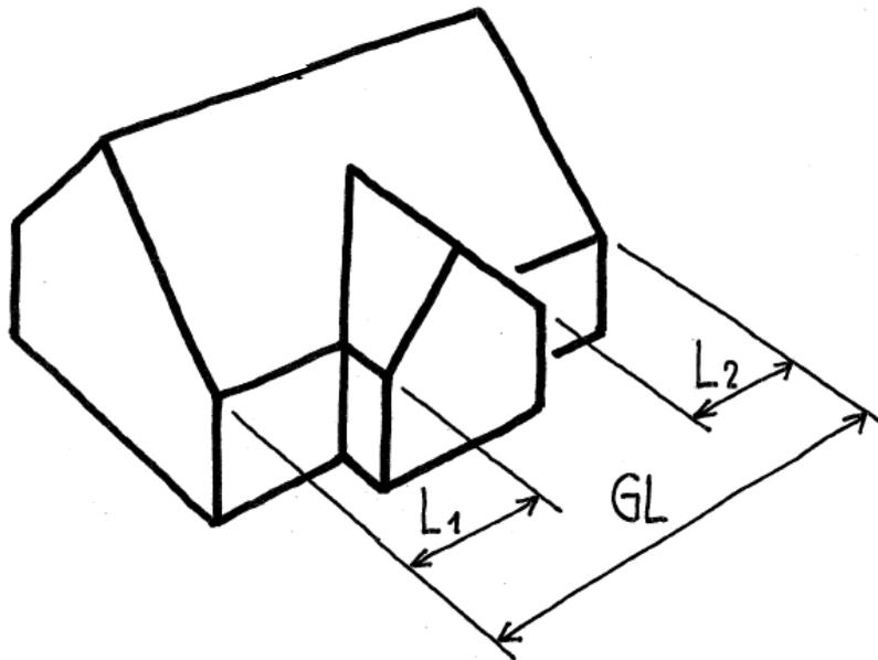
Trauflänge  $L_1 + L_2 = \text{min. } \frac{1}{2} \text{ Gebäudelänge } GL$
