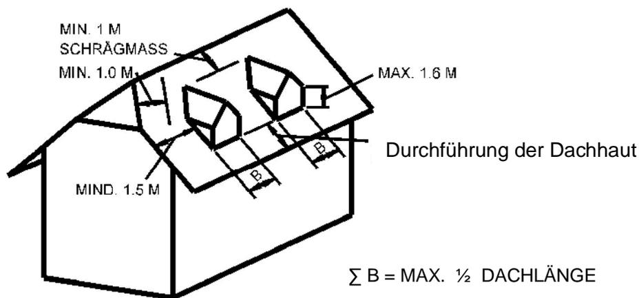
$\Sigma B = \text{MAX. } \frac{1}{2} \text{ DACHLÄNGE}$
