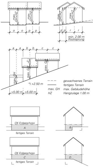
Mittlere Höhe zwischen OK Erdgeschossfussboden und fertigem Boden.
