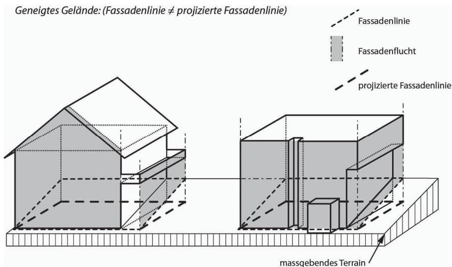
Figur 2.1b Fassadenflucht und Fassadenlinie (in geneigtem Gelände)
