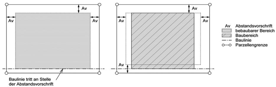
Figur 6.4 bebaubarer Bereich und Baubereich
