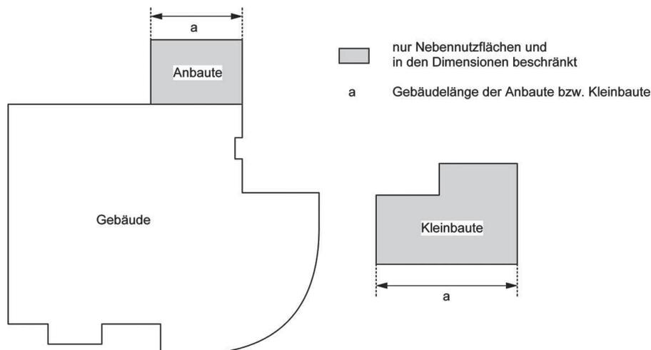
Figur 1.1 - 1.2 Gebäude, Anbauten und Kleinbauten
