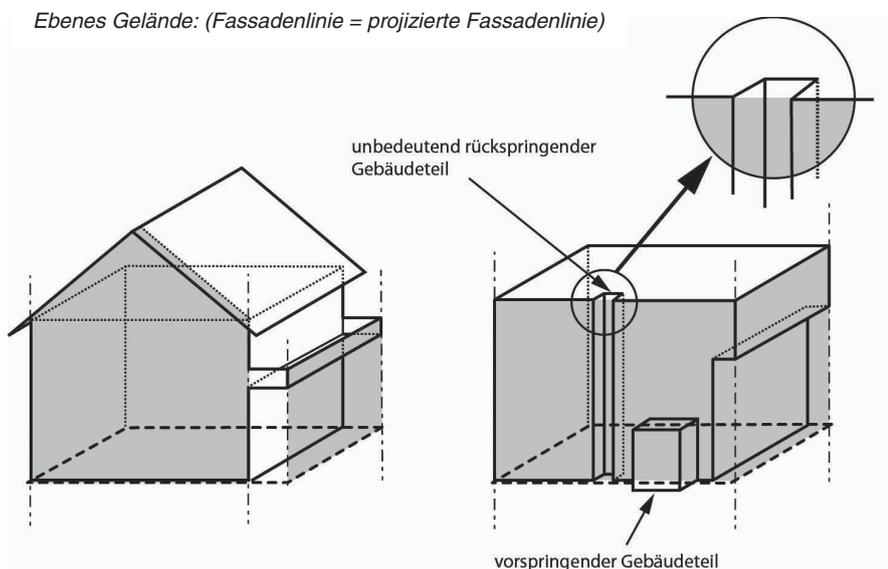
Figur 2.1a Fassadenflucht und Fassadenlinie (in ebenem Gelände)
