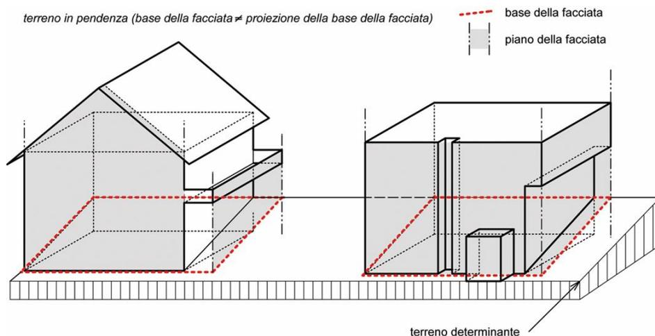
Figure 3.1 – 3.3: Piano della facciata e base delle facciate
