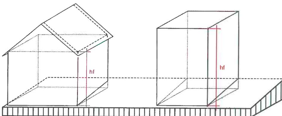
$hf$  = altezza delle facciate in gronda
