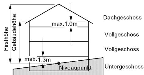
5 Die Gebäudehöhe bezeichnet den senkrechten Abstand zwischen dem Niveaupunkt und dem ausgemittelten Schnittpunkt der Fassade mit der Dachoberkante in der Fassadenmitte.
