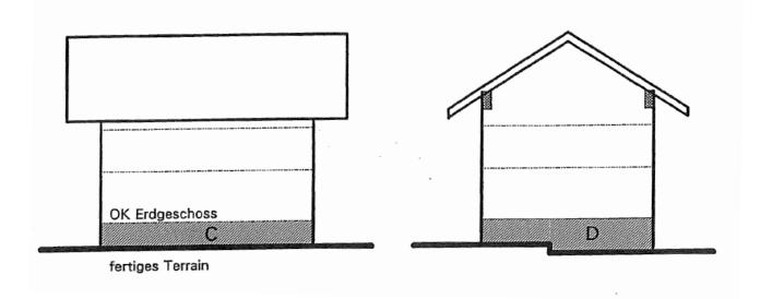
Mittlere Höhe zwischen OK Erdgeschossboden und fertigem Boden
