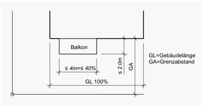
Falls die Fassadenfläche zu mehr als 50% durch Balkone bedeckt wird, ist der Grenzabstand von der äusseren Brüstung aus zu messen (vorderkant äusserem Balkonkonstruktionsteil).
