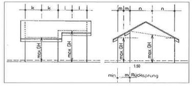
tung) in der Höhe gestaffelt ist und bei Bauten am Hang, die im Grundriss gestaffelt sind, ist die Gebäudehöhe für jeden dieser Gebäudeteile
