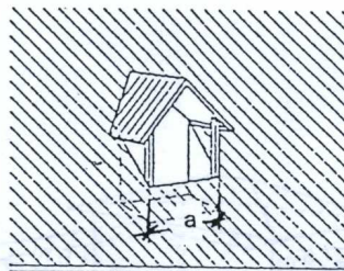
Dacheinschnitt mit Überdeckung
