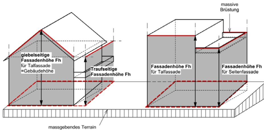
*Hinweis: In Abweichung von dieser Darstellung ist bei Attikageschossen gemäss § 5.6 und § 31 dieses Reglements auf der talseitigen Fassade ein Rücksprung von min. 2.00 m einzuhalten.*
